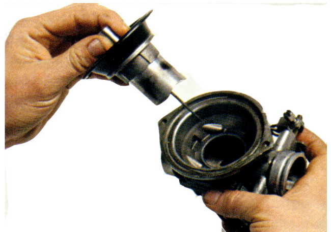
Abbildung 14: Entnehmen des Schiebers mit der Membrane
